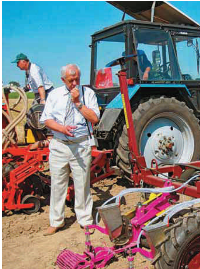
Директор РУП НИИ овощеводства, доктор с.-х. наук А.А. Аутко представляет комбинированный посевной агрегат АКП-4, который выполняет одновременное рыхление почвы в зоне образования гряд, формирования гребней, профилирование гряд и однозерновой пунктирный высев семян овощных культур. Разработчик — РУП НИИ овощеводства, изготовитель — РУП «Приборостроительный завод «Оптрон»
